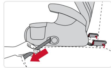
5. Para desplazar el asiento alzador hacia su sitio, tire de la correa del tensor del conector inferior para reducir sobrante.
