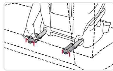
**IMPORTANTE:** Si no escucha un clic cuando conecte los conectores inferiores, es posible que la correa del tensor del anclaje inferior esté retorcida o que haya restos en el conector inferior. Solucione el problema antes de continuar con el proceso de colocación.
