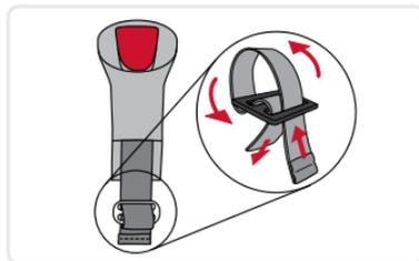
**NOTA:** El extremo inferior del clip del SecureGuard debe colocarse al nivel de los muslos superiores del niño una vez que esté colocado en el asiento regulable.
