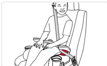
5. Pase la parte horizontal del cinturón de seguridad a través de la clavija SecureGuard (B).
